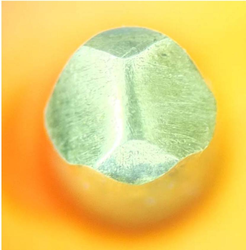
Figure 2 Goupille très usée : forme trapézoïdale de la pointe
