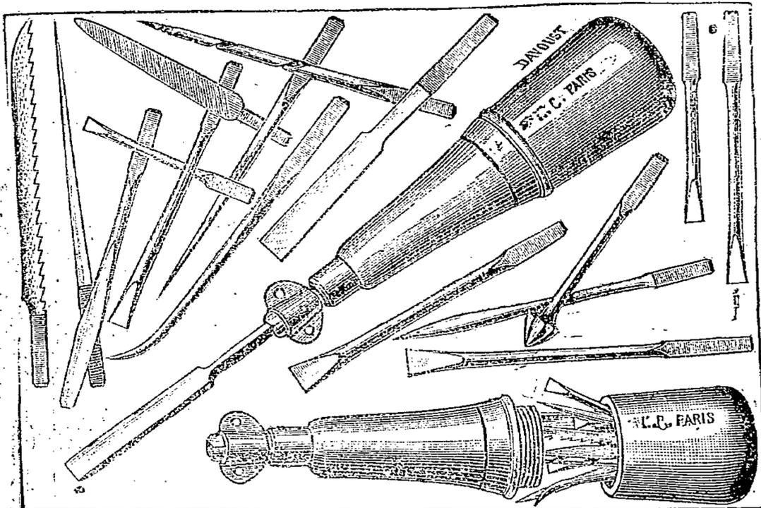
Cet appareil est composé d'un manche creux en bois dur, contenant tout un assortiment de dix outils, qui s'adaptent un à un à un écrou spécial figurant une douille à oreille placé sur le manche.
